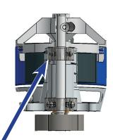
Patentierte Motor/Lagerkonstruktion mit einseitig vorgespanntem Doppellager und zweiteiliger Welle für hohe mechanische Belastung, ruhigen Lauf und präzises Schleifen.
